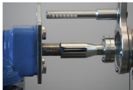
3. Connessione di APB/APS all'albero riduttore
