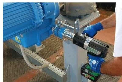
Attuatore APB/APS su Att. Elettrico DREHMO
